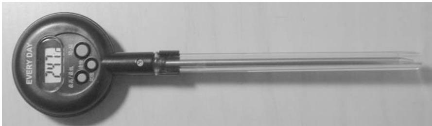
Foto IV-5. Termômetro: O termômetro apresenta leitura em Celsius ( $^{\circ}\text{C}$ ). Caso a leitura apresentada esteja em Fahrenheit ( $^{\circ}\text{F}$ ), solicite a presença do assistente de laboratório. Apenas leia a temperatura, não toque no termômetro!
